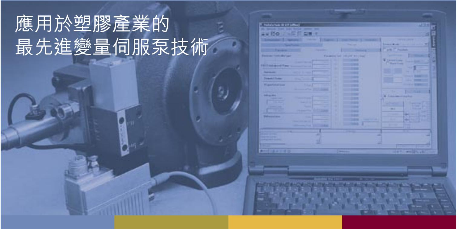
數位控制泵將帶有內建電路的比例電磁引導閥與徑向柱塞泵結合，執行局部閉回路、微調和診斷操作。數位控制泵是穆格為塑膠機精心研發而成的運動控制解決方案，提供性能和系統最佳化的效果，當中包括前所未有的“單參數微調”壓力調節。數位控制泵可透過CANopen 介面在閥上進行數位控制，或以類比裝置運作，有最大的靈活度與最強的功能性。
